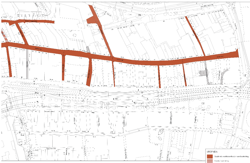
DWARRSSTEGEN KALVERSTRAAT GEPLANEERDE WERKZAAMHEDEN AAN BESTRATING
